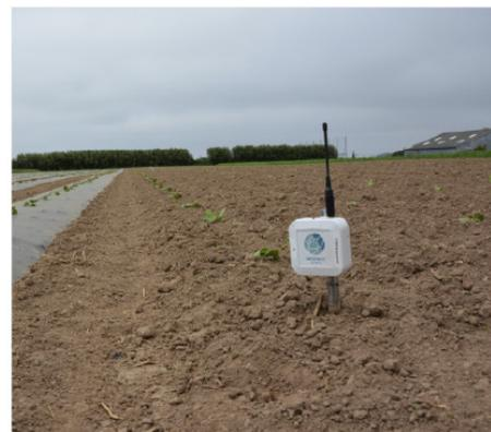
Les sondes tensiométriques mesurent l'état hydrique du sol.
